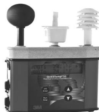
شكل (7): جهاز قياس الإجهاد الحراري المتكامل (WBGT) (Wet Bulb Globe Temperature Device)
