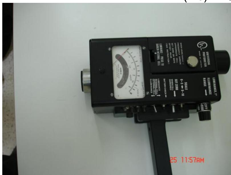
الشكل 6-2: جهاز قياس النصوع
