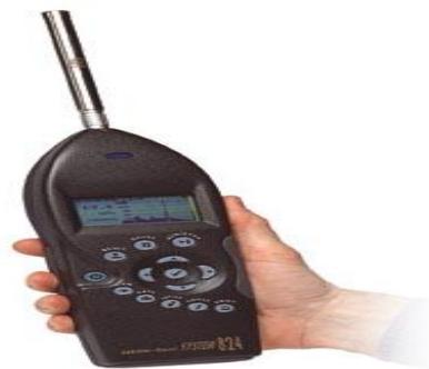
شكل 7-2: جهاز قياس مستوى الصوت مجهز بفلتر شريط ثمانى
