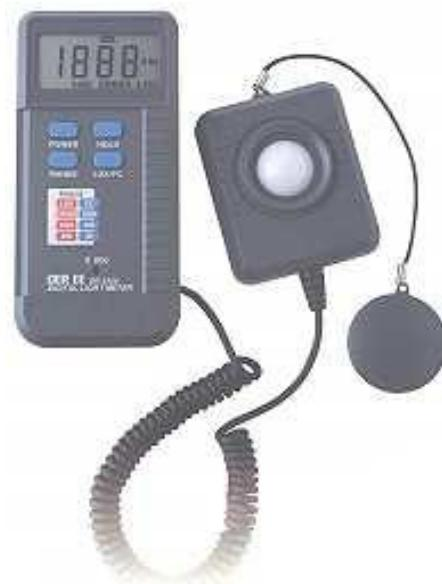
شكل 6-1: جهاز قياس شدة الضوء
