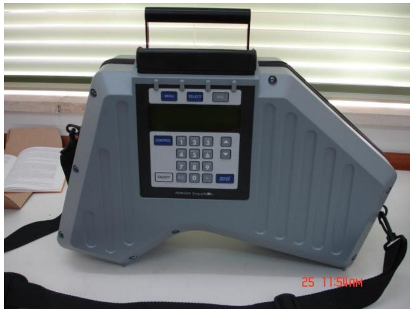
شكل 3-8: جهاز لتحليل الغازات والأبخرة يعمل على مبدأ الأشعة تحت الحمراء
