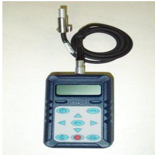
شكل 7-4: جهاز قياس الجرعة الصوتية
